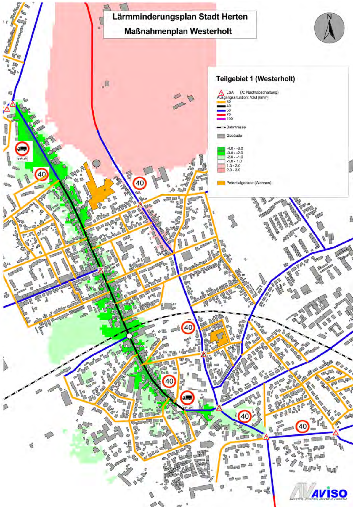
Bild 5.1: Maßnahmeneffekte nachts im Teilgebiet Westerholt (Pegelbereich: -3,1 bis +2,1 dB(A)) durch das Maßnahmenpaket M1
